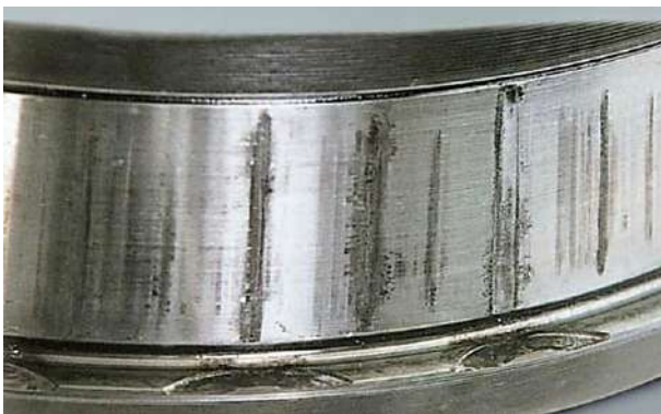
Рис. 2. Адгезионный износ (Неравномерная деформация поверхностей)
