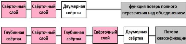
Рис. 2. Архитектура детекционной части нейросети YOLO v11
