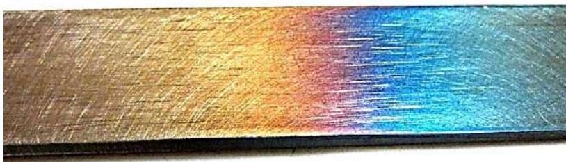
Рис. 3. Окисные пленки (Металлические поверхности меняют цвета)
