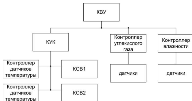
Рисунок 1 – иерархия системы управления отоплением в теплице
