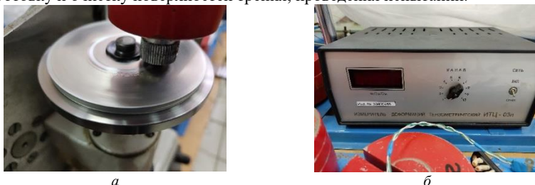
Рис. 1. Измерительная система: а – схема контакта «шар-плоскость», б – силоизмеритель
