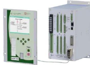
**ДЗТ.** Микропроцессорное устройство, предназначенное для осуществления функций дифференциальной защиты двухобмоточного трансформатора, измерения, регистрации, осциллографирования, сигнализации и управления выключателями на объектах энергетики с напряжением 6÷35 кВ.
