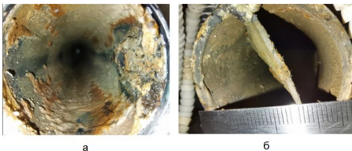
Рис. 2 - Загрязнения в трубном пространстве экспериментальных моделей: а – без ленточного завихрителя; б – с ленточным завихрителем.
