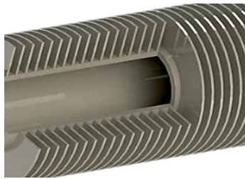
Рис. 1. Трехмерная модель трубы с наружным поперечным оребрением
