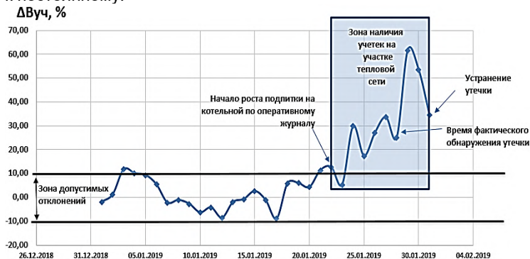
Рис. 1 Иллюстрация возможности определения участка тепловой сети с утечкой при мониторинге изменения значения V_{уч}
