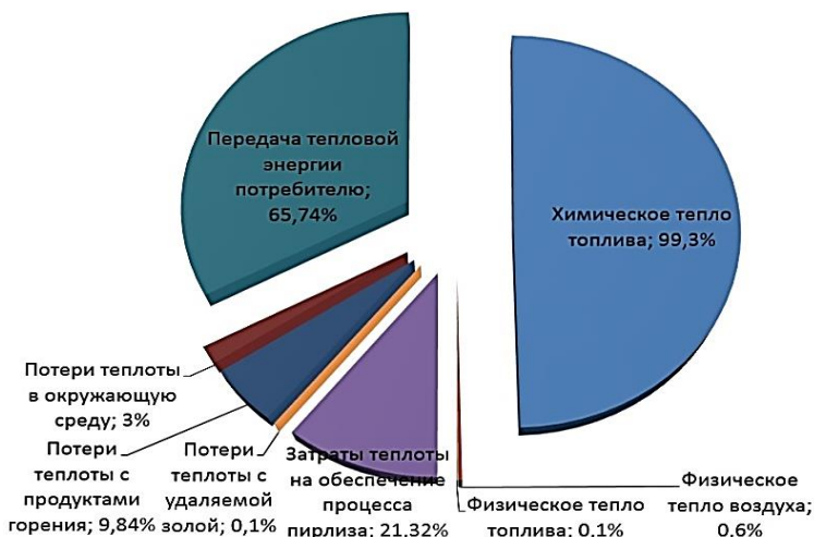
Рис. 2. Теплового баланса установки по переработке древесных отходов.
