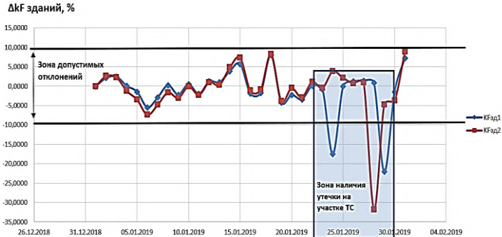
Рис. 2 Иллюстрация возможности определения участка тепловой сети с утечкой при мониторинге изменения значений kF зданий
