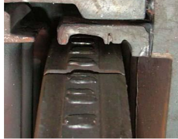
Рис. 2. Надбандажное радиальное уплотнение после задеваний
