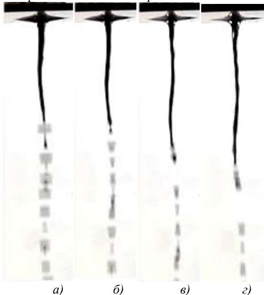
Рис. 5 Кинограмма струи магнитной жидкости в переменном магнитном поле с частотой 10 \text{ Гц} с амплитудой напряженности: H_{max} = 6,347 \text{ кА/м} во временные промежутки от начала эксперимента: а) 0,3330 \text{ с} ; б) 0,3429 \text{ с} ; в) 0,3561 \text{ с} ; г) 0,3660 \text{ с}
