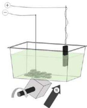
Рис. 1. Установка для металлизации, состоящая из кюветы с электролитом и порошком, а также вращающегося магнита, приводящего в движение частицы в порошке
