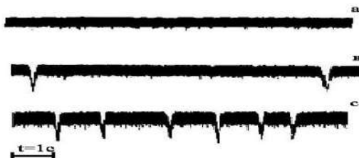
Рис. 2. Характерный вид осциллограмм, полученных в переменных магнитных полях низкой частоты (менее 10Гц)
