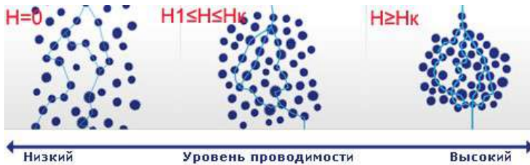
Рис. 4 механизм изменение электропроводности под действием магнитного поля на образец. Поле приложено в направлении протекания тока
