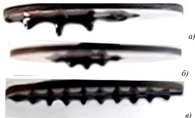
Рис. 6. Растекание капли магнитной жидкости в переменном магнитном поле с различными частотами: а) 30 Гц; б) 50 Гц; в) 60 Гц с амплитудой напряженности: H_{max} = 7 кА/м.
