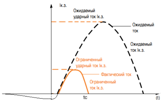
Рис. 1. Ожидаемый ударный ток и ограниченный ток
