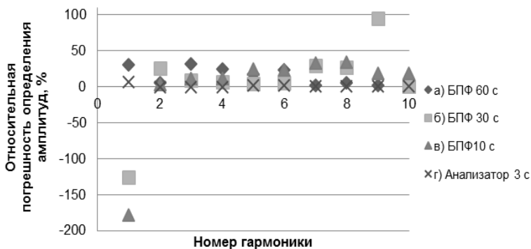
Рис. 2. Относительная погрешность определения амплитуд
