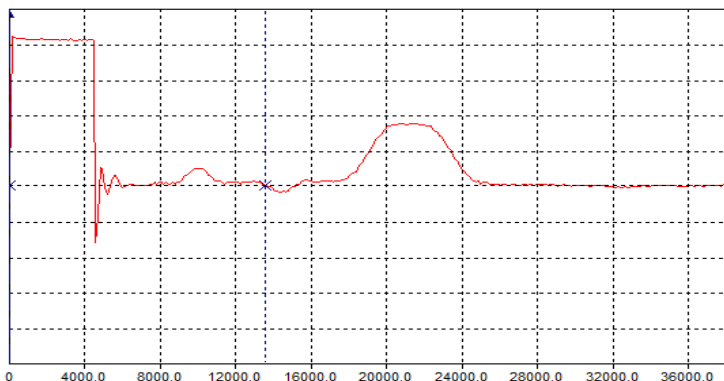
Рис. 2. Отражение зондирующего импульса от места обрыва ЛЭП
