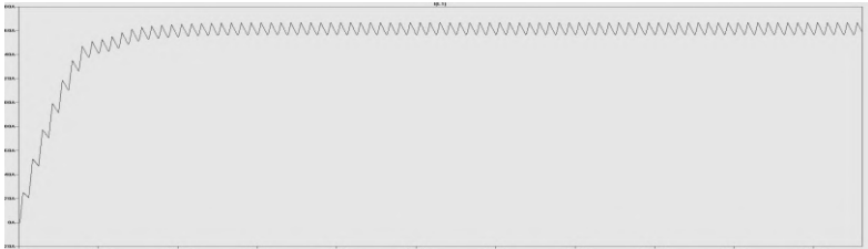
Рис. 2. Результат моделирования тока на дуге
