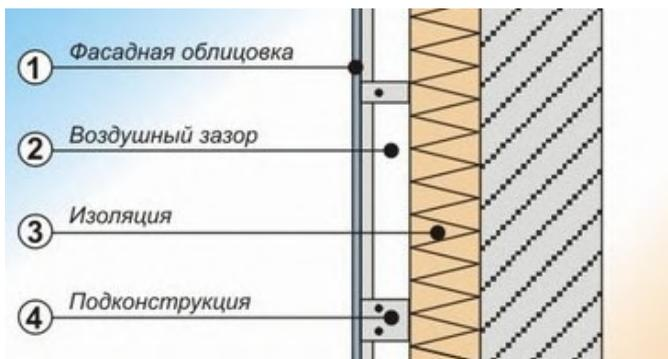
Рис. 1. Конструкция навесного вентилируемого фасада
