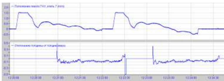
Рис. 4. Прокатка полосы с включенной системой коррекции толщины головного участка
