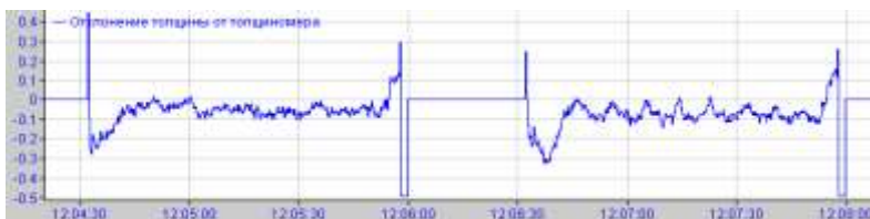
Рис. 1. Отклонения выходной толщины полосы на выходе стана 2000
