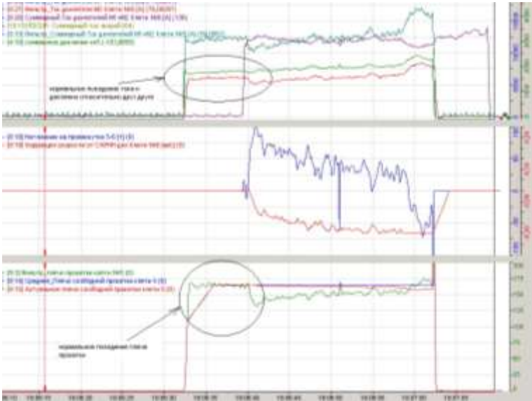
Рис. 2. Осциллограммы координат электроприводов при прокатке полосы в смежных клетях черновой группы
