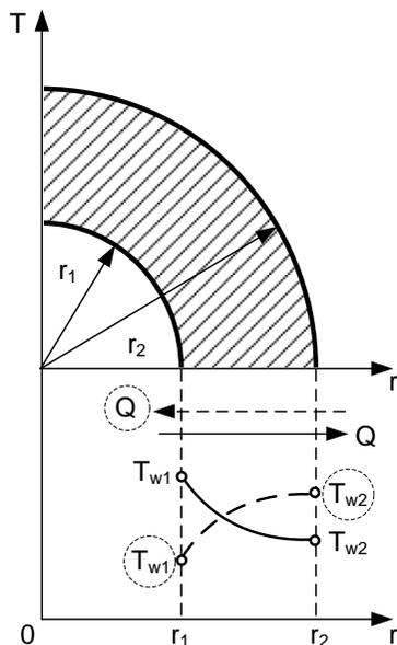
Рис. 2.3. Стационарное температурное поле в шаровой стенке
