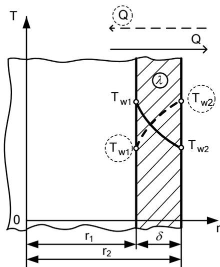
Рис. 2.2. Стационарное температурное поле в цилиндрической стенке
