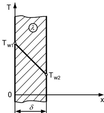
Рис. 2.1. Стационарное температурное поле в плоской стенке
