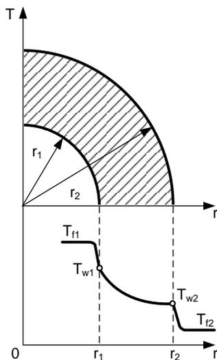
Рис. 2.6. Теплопередача через шаровую стенку
