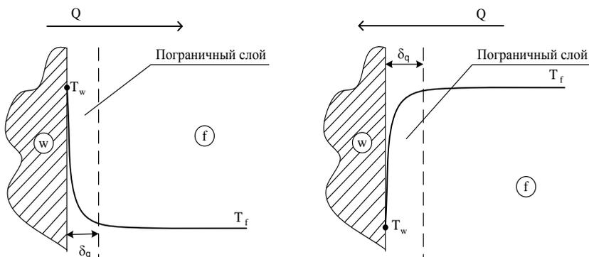
Рис. 1.4. Схема процесса теплоотдачи:
